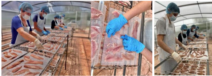
Figura 7 Ubicación de filete de pescado fresco y deshidratado dentro de los secadores solares tipo invernadero.
